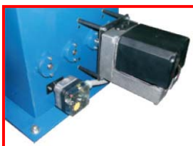
Reglarea debitului de aer
